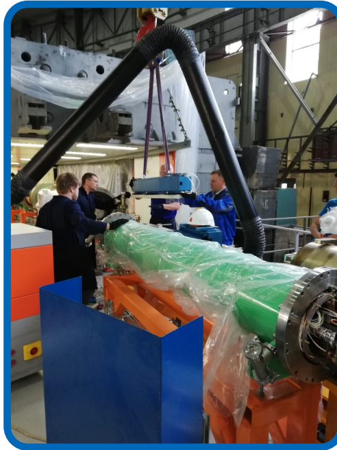
Установка септум-магнита системы быстрого вывода, изготовленной в ИЯФ им. Г.И. Будкера. Installation of the septum-magnet of the Fast Beam Extraction system produced at Budker INP.
